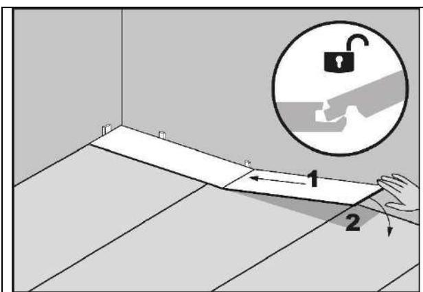
Вставляем короткий край следующей доски под углом примерно 20° к первой и опускаем. Соединенные доски должны быть уложены точно в линию
