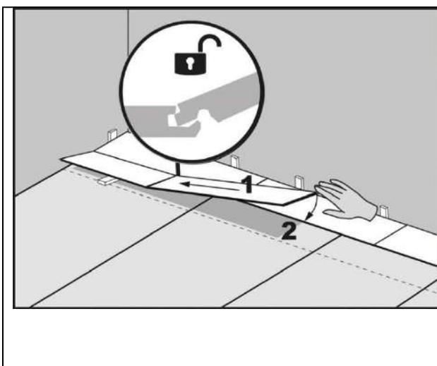
Далее следующую плитку соединяем по короткой стороне таким образом, чтобы шип по длинной стороне лёг поверх паза плитки предыдущего ряда, затем приподняв на 20 градусов обе планки сдвигайте последнюю плитку до полного защёлкивания замка по длинной стороне с плиткой предыдущего ряда.
