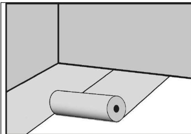
Раскладываем пароизоляционную пленку. Соседние крепятся встык друг к другу и склеиваются металлизированной лентой. Края пленки заводятся на стены на 10-20 мм
