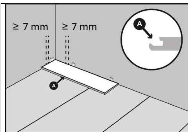
Укладка плитки осуществляется последовательно слева направо двигаясь на себя. Обычно выбирают тот угол комнаты (от которого начнется укладка), к которому плитка прилегает шипами короткой и длинной стороны. Укладывается «шип-в-паз»
